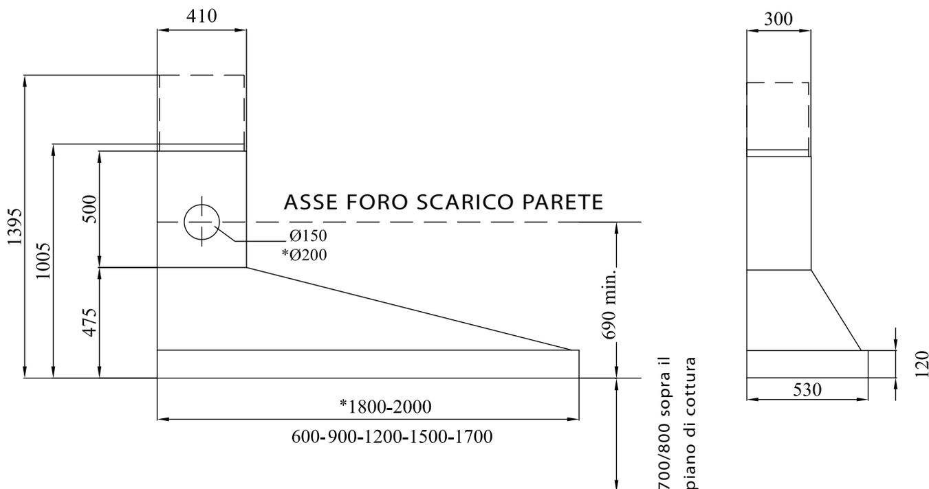
Non collegare la cappa ad uno scarico ridotto rispetto a quello previsto. Rischio di malfunzionamento e surriscaldamento del motore. Nel caso non fosse possibile predisporre lo scarico  $\varnothing$  200 mm (1200 mc/h), ove previsto come standard (KD180-200), si consiglia di richiedere la cappa con motore per scarico  $\varnothing$  150 mm (900 mc/h).
